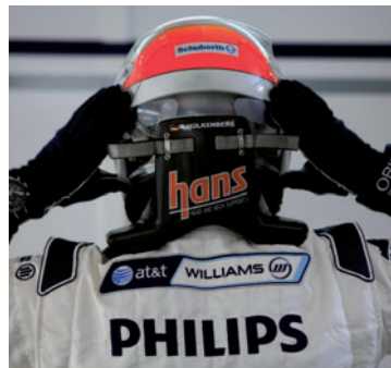
HANS wird am Helm mit dem Fahrer verbunden.
